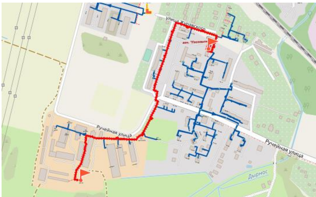
Рисунок 41. Путь движения теплоносителя Кот. Госопытная – нефтехранилище
