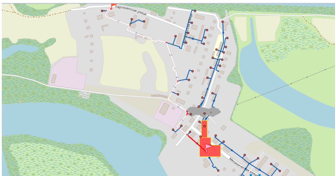
Рисунок 19. Путь движения теплоносителя Котельная "Вильтыдор- ул. Дачная, д.9
